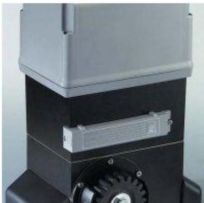
Привод **FAAC 844** предназначены для автоматизации сдвижных ворот. Вращательное движение выходной звездочки преобразуется в поступательное с помощью зубчатой рейки, закрепленной на воротах. Самоблокирующийся редуктор привода позволяет запирают ворота без установки дополнительных запирающих устройств.
